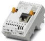
Адаптер связи позволяет быстро и просто встроить восемь разделительных усилителей и измерительных преобразователей MINI Analog Pro в сеть Modbus/TCP.
