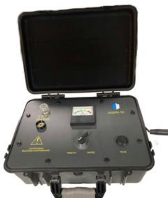
Аппарат с определителем мест повреждений изоляции шахтных электроустановок импульсным повышенным напряжением АШИК-1К, с ручным генератором
