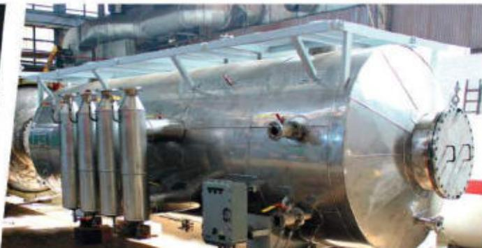
Емкость разрядная для сброса пластовой воды, нефти и химреагентов
