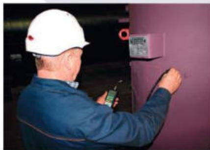
Замер толщины антикоррозийного покрытия
