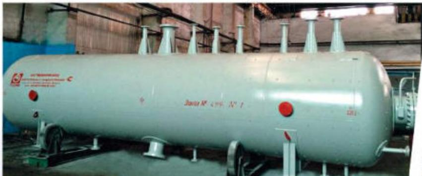
Аппарат емкостной объемом 28 м<sup>3</sup>
