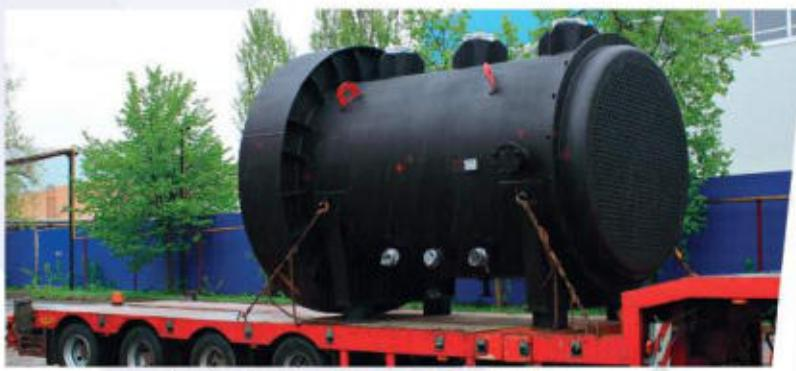
Трубный пучок котла-утилизатора диаметром 2200 мм
